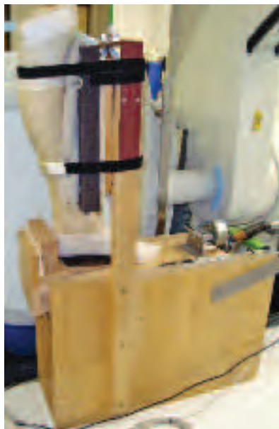
6 Die Ideen für unkonventionelle Messmethoden gehen der Arbeitsgemeinschaft nicht aus. In Analogie zu einem in früheren Studien eingesetzten „Knietester“ entwickelte die Arbeitsgruppe jüngst einen „Ankle tester“, der den so genannten Talusvorschub, also die translatorische Bewegung des Sprungbeines gegenüber der Tibia, messen kann. Das Gerät besteht aus zwei durch einen Gleitmechanismus verbundene Teile: Teil A besteht aus einer variabel anpassbaren Platte (Drehkurbelmechanismus) und einem darauf angebrachten anatomischen Shin pad für die Anpassung an das vordere Schienbein. Teil B besteht aus einer plantaren Platte, auf der die gesamte Fußsohle ruht, und einer Fersenschale. Durch einen Gleitmechanismus werden Teil A und Teil B in Höhe des außenseitigen oberen Sprunggelenks verbunden. Der Mechanismus lässt eine translatorische Bewegung im Sinne des Talusvorschubes zu. Im Rahmen ihrer Promotion bei Prof. Heinz Lohrer setzt Tanja Nauck dieses Messgerät derzeit für eine Studie ein.
