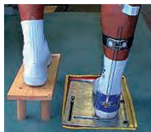
4a, b Testapparat zur Simulation von Supinationsbewegungen: Diese Plattform kann sowohl aus statischer Ausgangsposition (4a) als auch aus einer Gehbewegung heraus – wenn die Platte in eine Gangway integriert wurde (4c) – plötzliche Bewegungen im Sprunggelenk induzieren. Am Sprunggelenk ist ein Goniometer zur Bestimmung des Ausmaßes und der Geschwindigkeit der Supinationsbewegungen angebracht.
