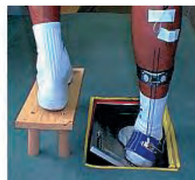
4a, b Testapparat zur Simulation von Supinationsbewegungen: Diese Plattform kann sowohl aus statischer Ausgangsposition (4a) als auch aus einer Gehbewegung heraus – wenn die Platte in eine Gangway integriert wurde (4c) – plötzliche Bewegungen im Sprunggelenk induzieren. Am Sprunggelenk ist ein Goniometer zur Bestimmung des Ausmaßes und der Geschwindigkeit der Supinationsbewegungen angebracht.
