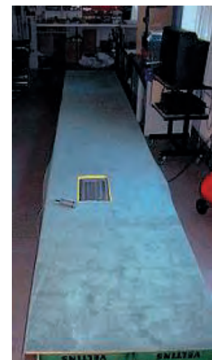
4a, b Testapparat zur Simulation von Supinationsbewegungen: Diese Plattform kann sowohl aus statischer Ausgangsposition (4a) als auch aus einer Gehbewegung heraus – wenn die Platte in eine Gangway integriert wurde (4c) – plötzliche Bewegungen im Sprunggelenk induzieren. Am Sprunggelenk ist ein Goniometer zur Bestimmung des Ausmaßes und der Geschwindigkeit der Supinationsbewegungen angebracht.
