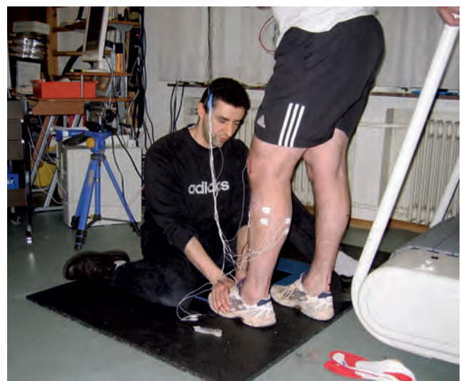
1 Dr. Oliver Ludwig beim Anlegen der Sensoren für die EMG-Messung.
