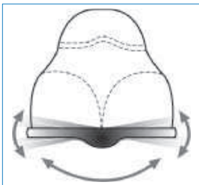
Der in Längsrichtung angebrachte halbe Zylinder erzeugt eine seitliche Instabilität, die sensomotorische Reize auslöst.
