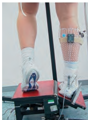
2 Messung der peronealen Reaktionszeiten und der Eversionsbewegung des Rückfußes (beim Tragen einer gelenkstabilisierenden Orthese) auf einer mechanisch ausgelösten Kippplattform (Eigenbau); der kontralaterale Fuß wird zum Balancieren nur leicht aufgesetzt. Über eine Fersenkappe im Schuh wird die Rückfußbewegung auf ein Elektrogoniometer übertragen und in bezug auf den Unterschenkel gemessen.
